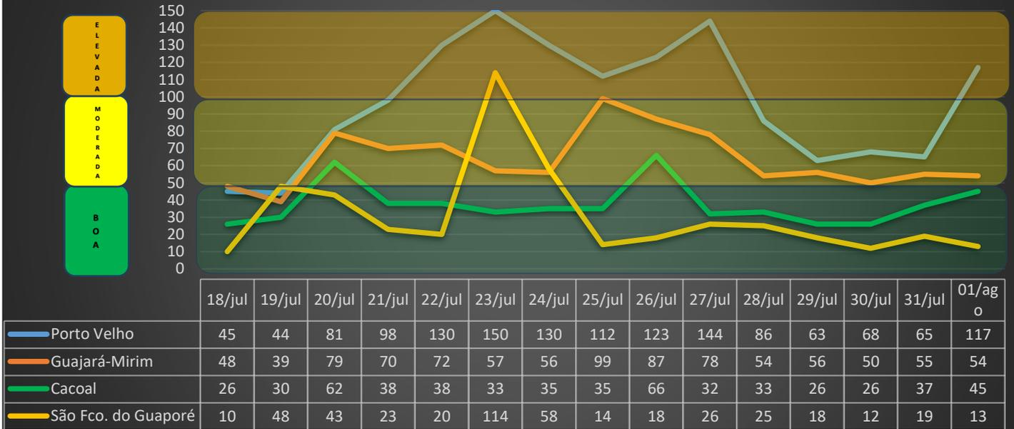
Os valores das colunas representam a concentração média de PM2.5 (em  $\mu\text{g}/\text{m}^3$ ) medida em um intervalo de 10 minutos, conforme padrão AQI US EPA.
