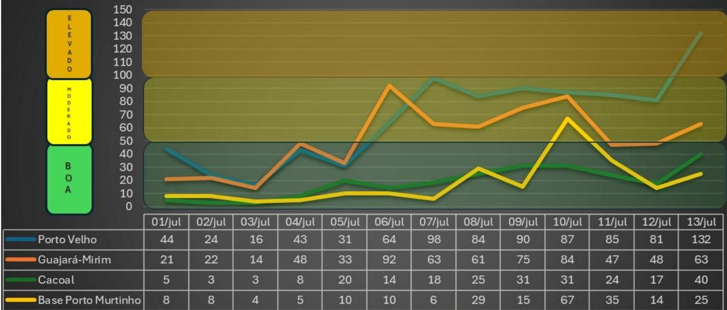
Os valores das colunas representam a concentração média de PM<sub>2.5</sub> (em Bµg/m<sup>3</sup>) medida em um intervalo de 10 minutos, conforme padrão AQI USEPA.
