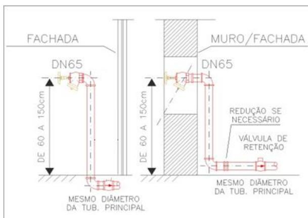
**Figura 1** – Dispositivo de recalque tipo coluna
