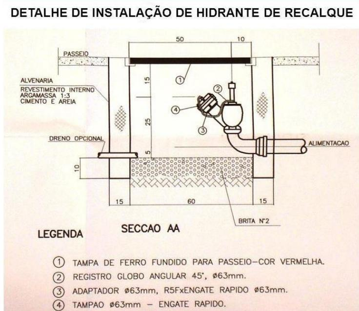
**Figura 2** – Dispositivo de recalque no passeio público
