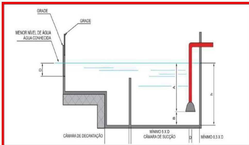
**Figura B.4** – Alimentação natural do reservatório de incêndio
