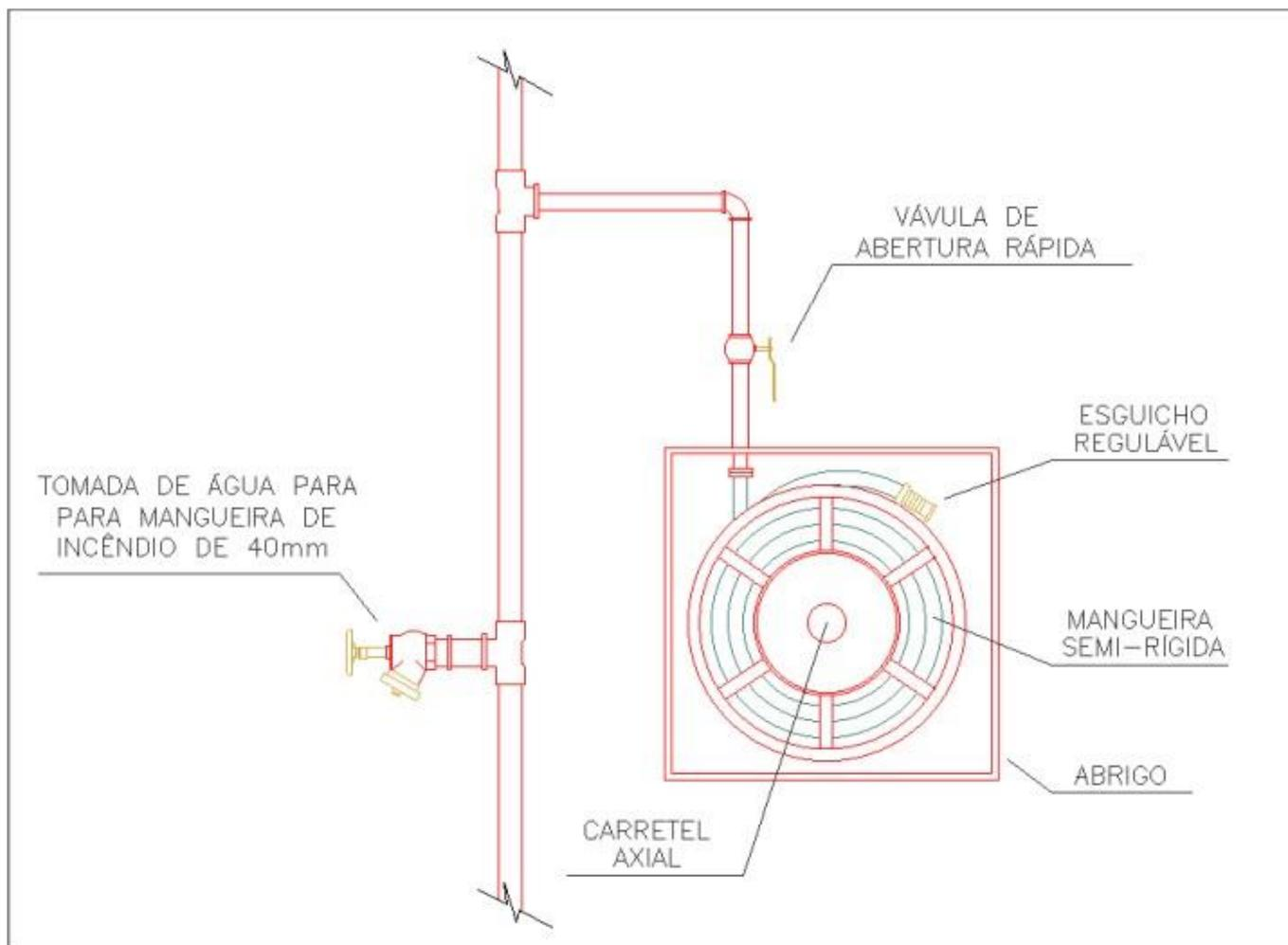
**Figura A.1** - Exemplo de instalação de sistema de mangotinho com válvula globo angular prumada, para emprego pelo Corpo de Bombeiros, em caso de uso do dispositivo de recalque da edificação.
