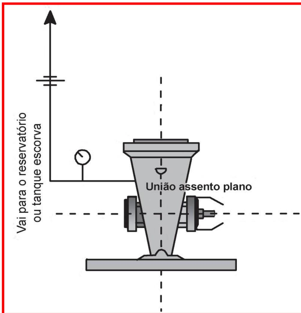
**Figura C.7** – Arrefecimento da bomba principal elétrica
