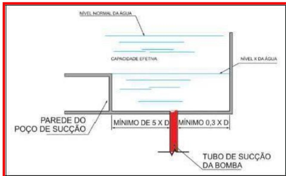
**Figura B.3** – Tomada inferior de sucção para bomba principal
