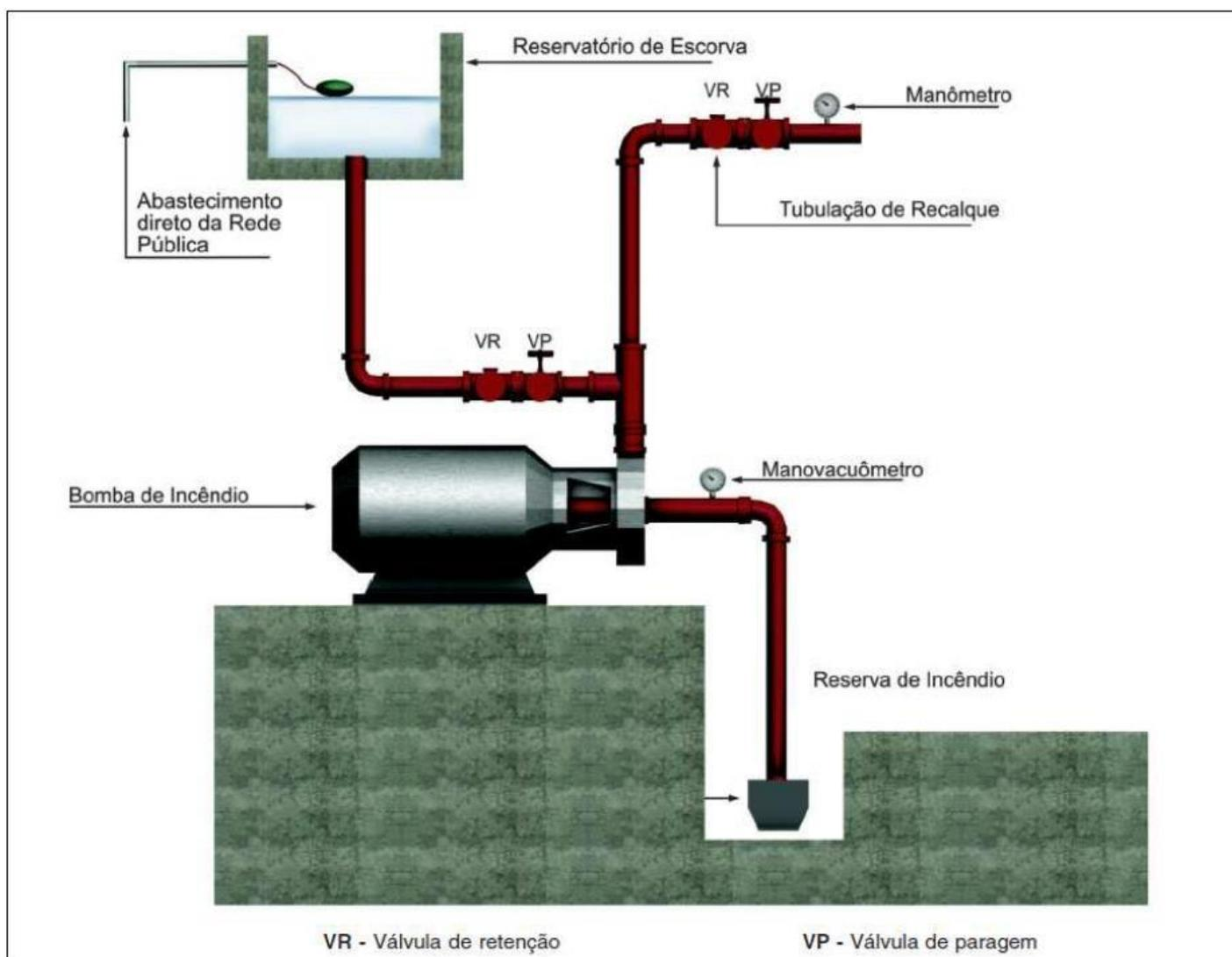
**Figura C.3** – Exemplo de afofamento de bomba de incêndio
