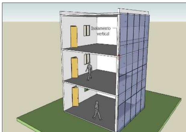
**Figura 08:** *Compartimentação vertical de fachada*
