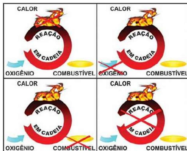
Figura 10 – Mecanismo de extinção do fogo
