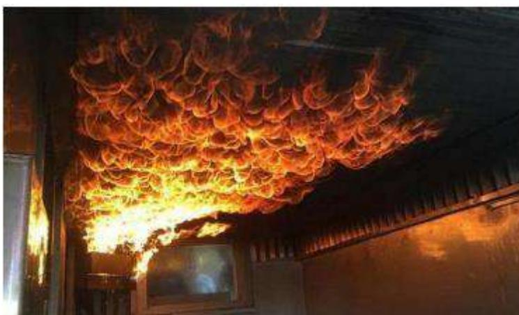
**Figura 12.1** – Fase anterior ao flash over – grande desenvolvimento de fumaça e gases, acumulando-se no nível do teto (Fonte: rede mundial de computadores)
