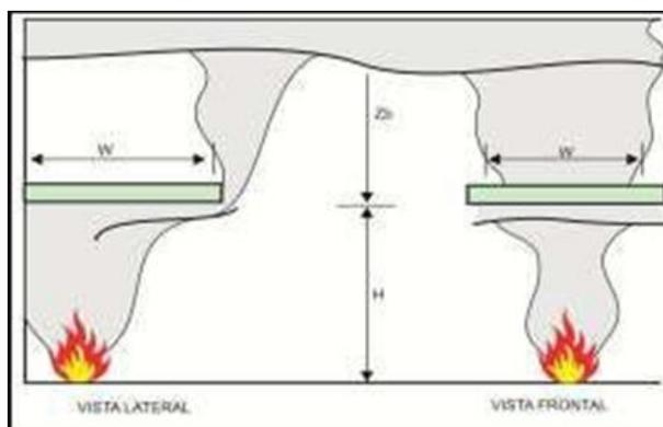
Figura 41 – Coluna de fumaça saindo de um balcão
