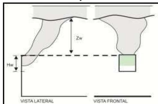
Figura 42 – Coluna de fumaça saindo por aberturas (janelas)
