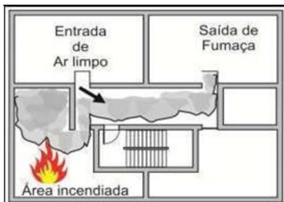
**Figura 24** – Extração mecânica
