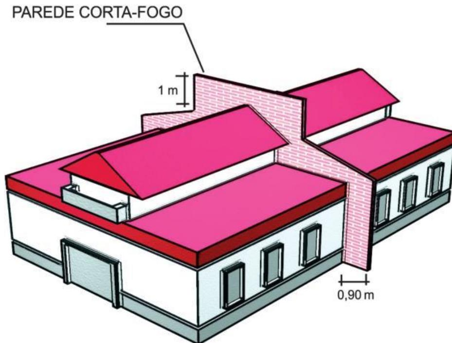
**Figura 8** – Parede corta-fogo
