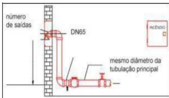
Figura 1 – Dispositivo de recalque tipo coluna
