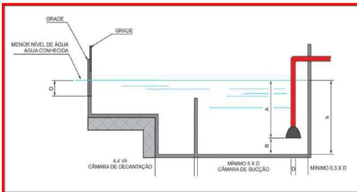
Figura B.5 – Alimentação natural de reservatório por canal
