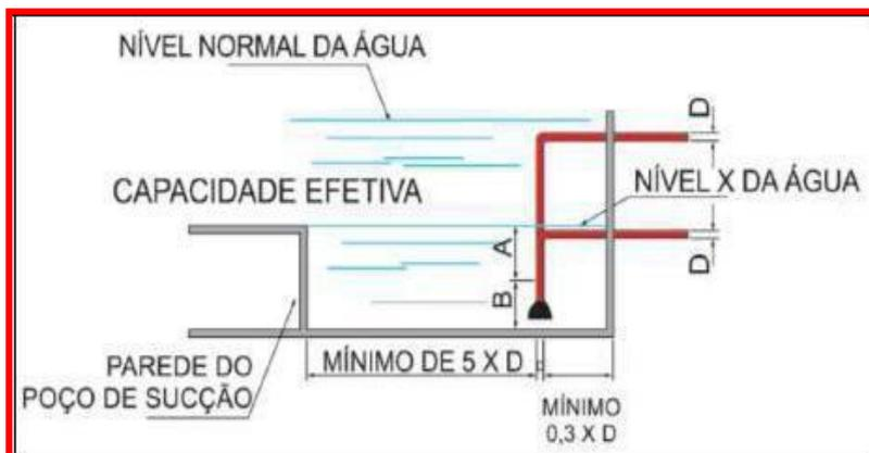
Figura B.1 – Tomada superior de sucção para bomba principal
