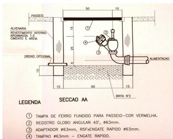
Figura 2 – Dispositivo de recalque no passeio público
