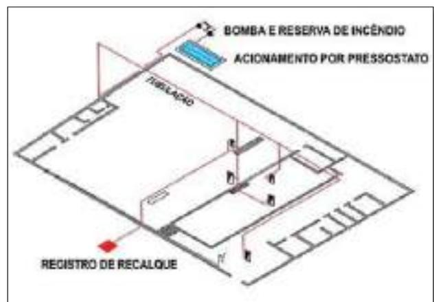
**Figura 49** – Isométrica de sistema de hidrantes
