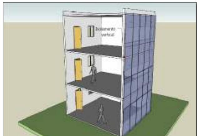
**Figura 08:** Compartimentação vertical de fachada
