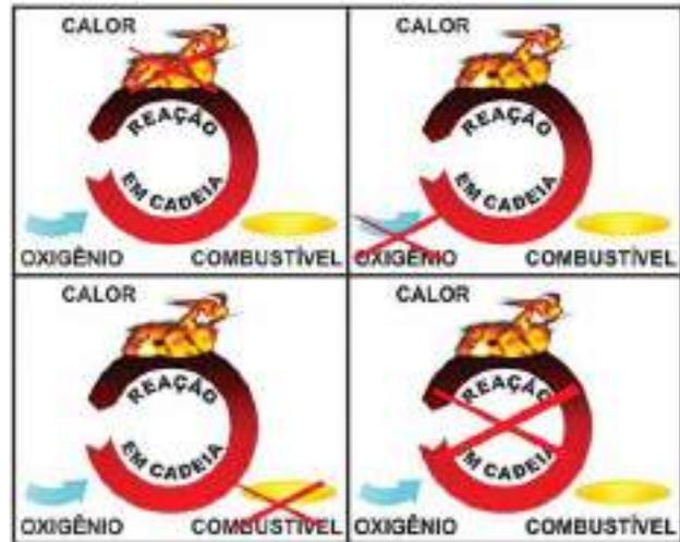
Figura 10 – Mecanismo de extinção do fogo
