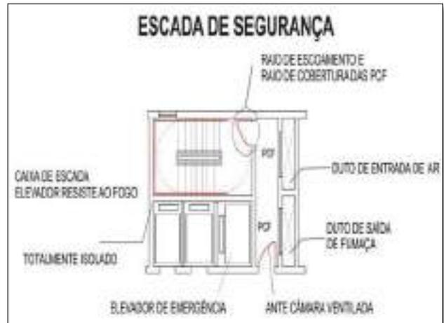
Figura 35 – Escada e elevador à prova de fumaça
