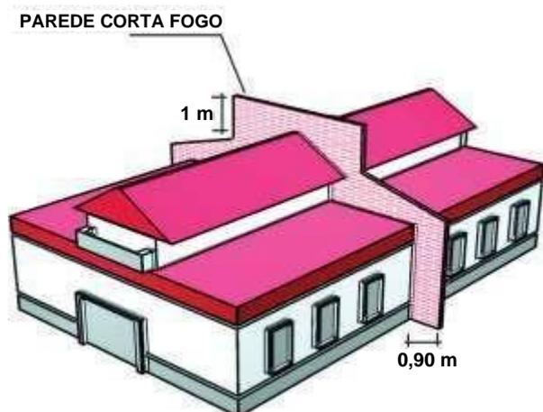
Figura 8 – Parede corta-fogo
