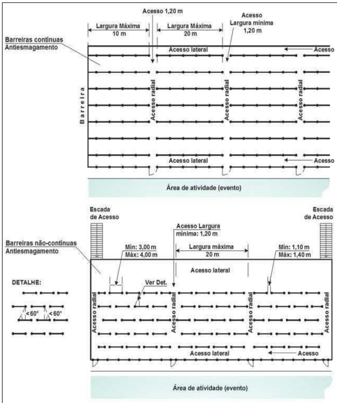
Figura 10 – Barreiras antiesmagamento – contínuas e não contínuas
