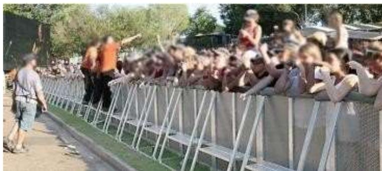
**Figura H.6 b** - Barreiras antiesmagamento com plataformas de apoio
