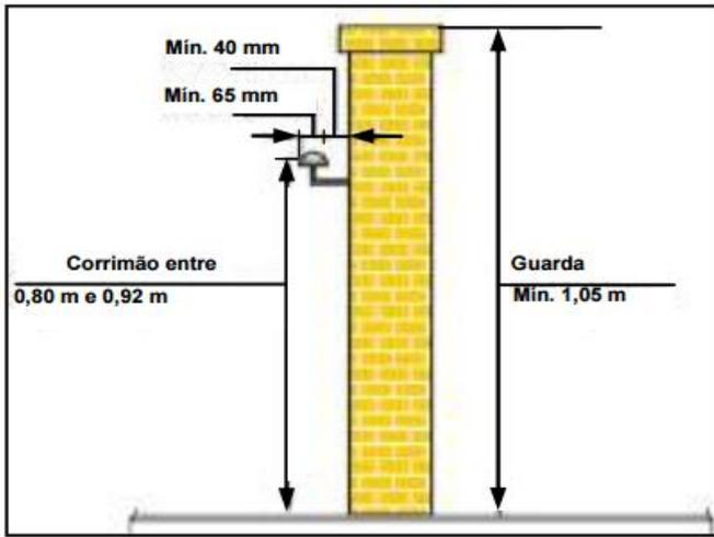
Figura 14 – Dimensões de guardas e corrimãos
