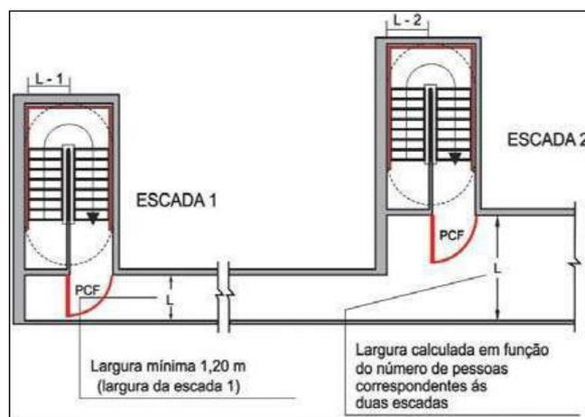
**Figura 19** - Dimensionamento dos corredores de descarga
