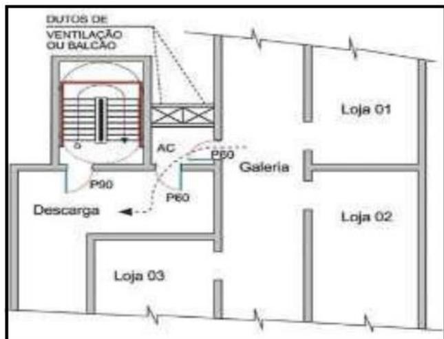
**Figura 20** – Acesso e galeria comercial à descarga
