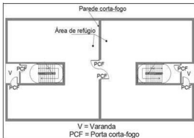
**Figura 17** – Desenho esquemático da área de refúgio
