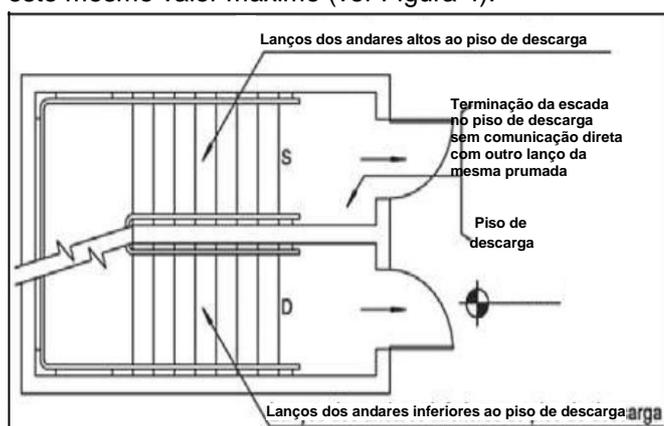
**Figura 3** – Segmentação das escadas no piso da descarga
