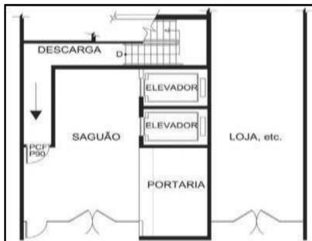
**Figura 18** – Descarga através de hall térreo não-enclausurado
