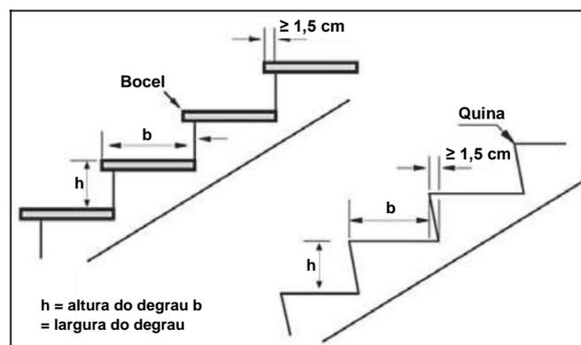
**Figura 4** – Altura e largura dos degraus
