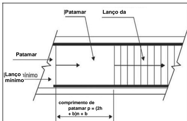
**Figura 5** – Lanço mínimo e comprimento de patamar
