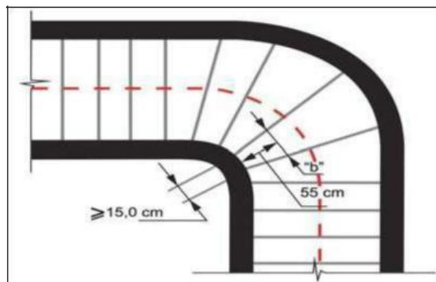
**Figura 6** – Escada com laços curvos e degraus balanceados
