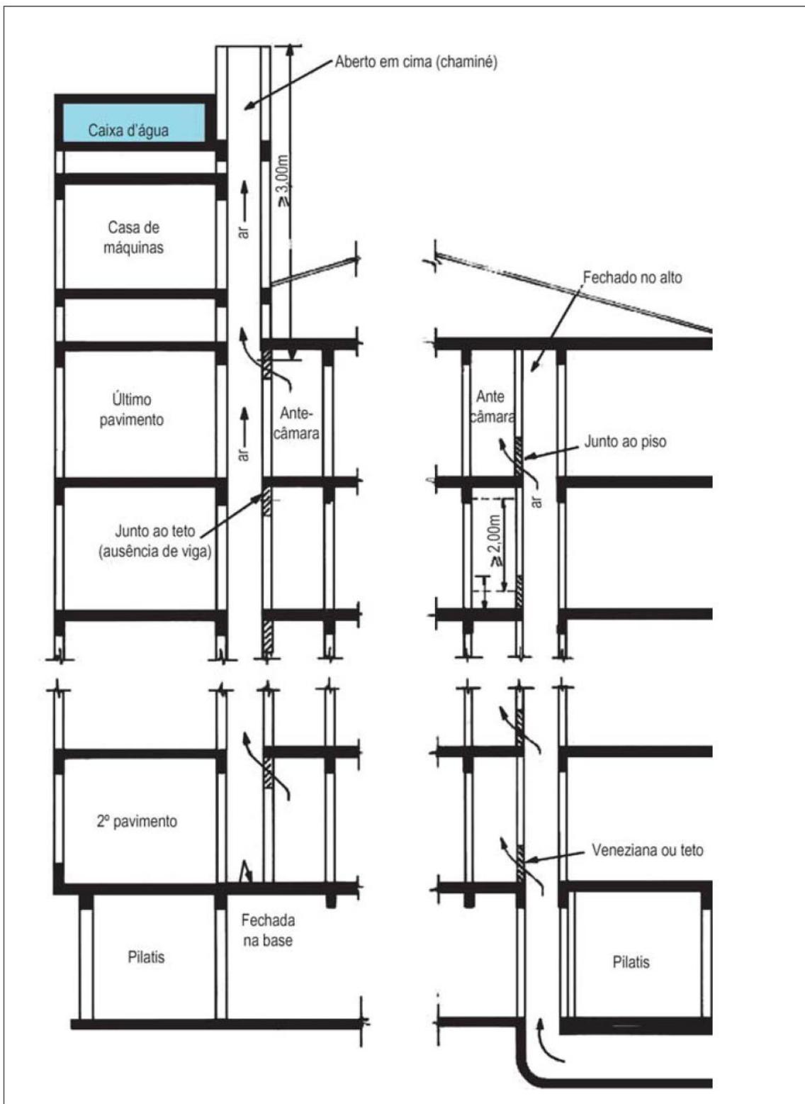
Figura 10 – Exemplo de dutos de ventilação
