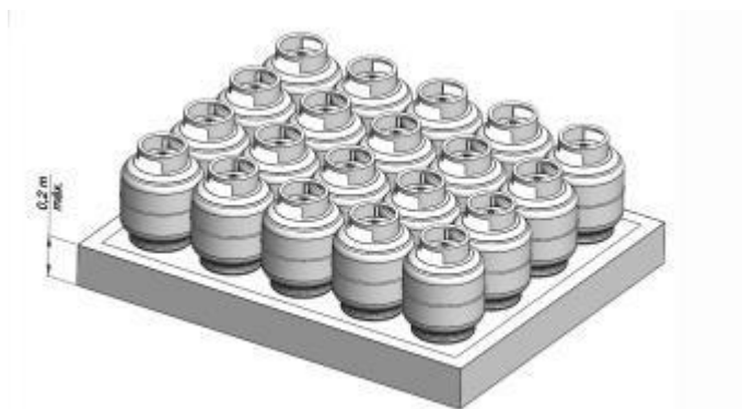
Figura 3 – Exemplo de Armazenamento com Piso Elevado sem Corredor de Circulação
