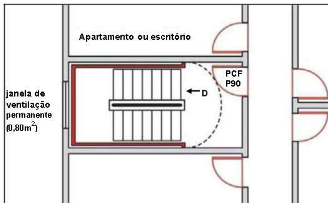
FIGURA 7 – Escada enclausurada protegida
