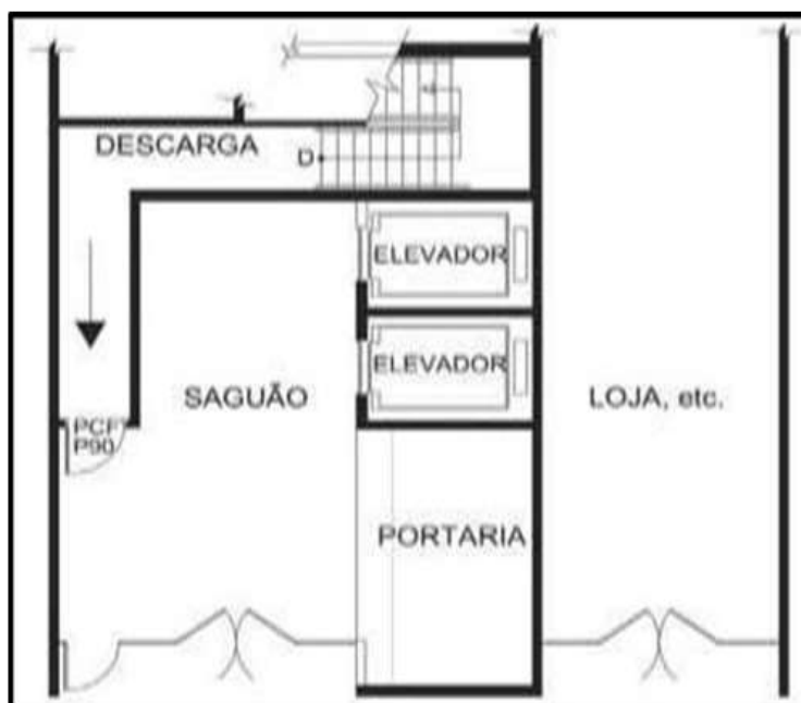
FIGURA 18 – Descarga através de hall térreo não-enclausurado
