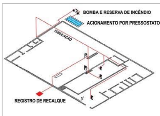
Figura 49 – Isométrica de sistema de hidrantes
