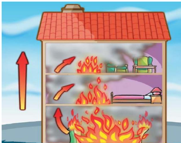
Figura 14 – Propagação por convecção, em que gases quentes fazem com que ocorram focos de incêndio em andares distintos (Fonte: Escola Nacional de Bombeiros, Fenomenologia da Combustão e extintores, Volume VII)
