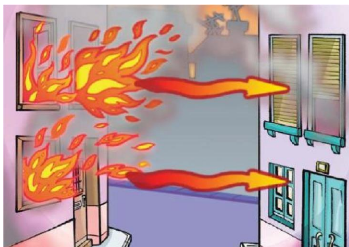
Figura 15 – Radiação de calor de um edifício para outro (Fonte: Escola Nacional de Bombeiros, Fenomenologia da Combustão e extintores, Volume VII)
