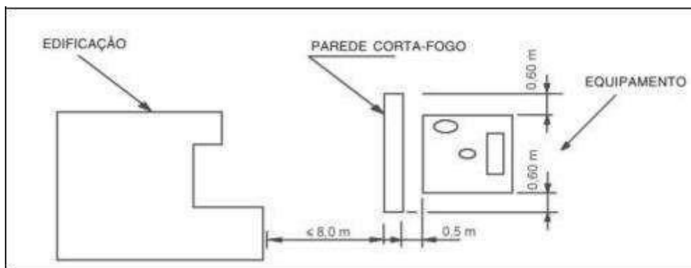
Figura 2 – Separação por parede corta-fogo
