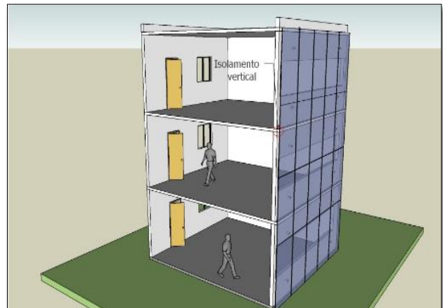
Figura 08: Compartimentação vertical de fachada
