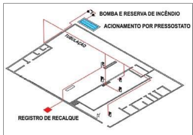
Figura 49 – Isométrica de sistema de hidrantes
